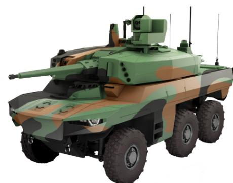
Le JAGUAR est un engin blindé de reconnaissance et de combat 6X6 de 25 tonnes qui doit progressivement venir remplacer à partir de 2020 les AMX-10RC, les VAB HOT et les ERC 90.
